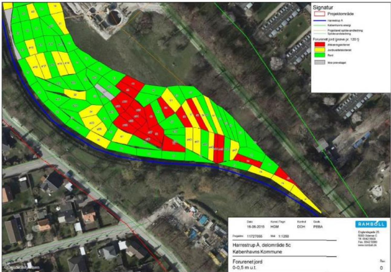
Figur 8-2. Eksempel på plan over forklassificering med prøverne fra 0-0,5 m i midten af delområde C.
