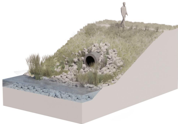
Figur 3-2 Principskitse af justering af Ø700 mm rørudløb til Harrestrup Å på projektstrækningen hvor rørudløbet er placeret i den øverste del af dobbeltprofilen.
