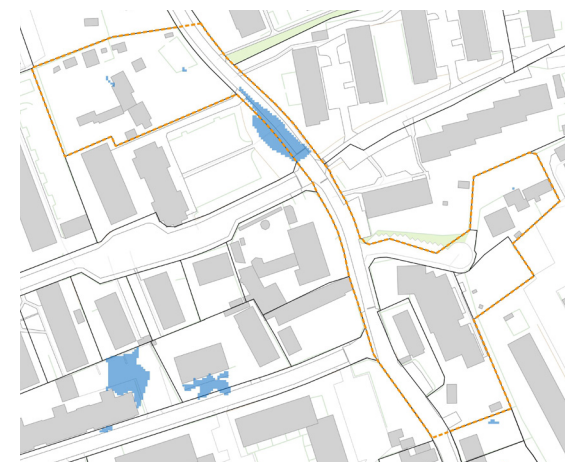
Kortet viser de arealer, hvor der forventes mere end 10 cm vand på terræn ved skybrud ved en 100-årshændelse i år 2118.
